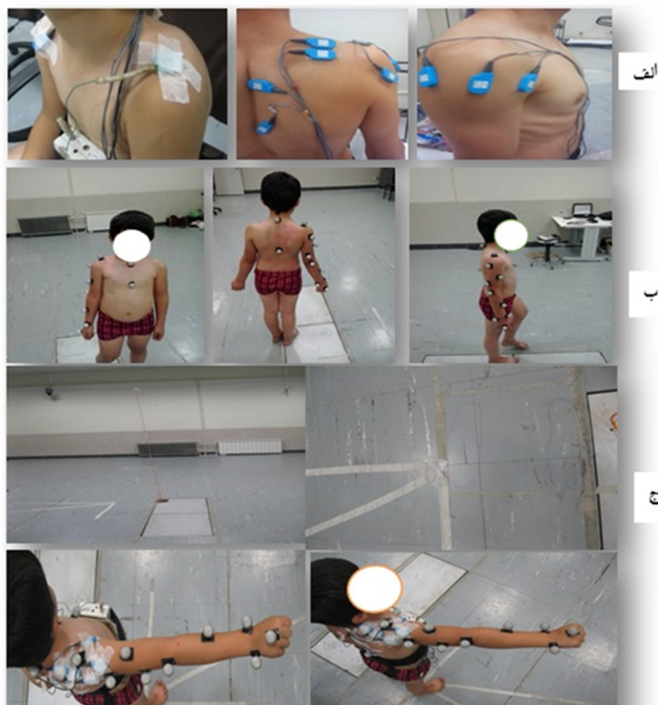
شکل ۱-الف. اتصال الکترودهای الکترومیوگرافی - ب. اتصال مارکرها روی نقاط آناتومیکی نشانگر اندام های خاص - ج. محل قرارگیری دست در صفحه های فرونتال و اسکپشن از نمای بالایی
