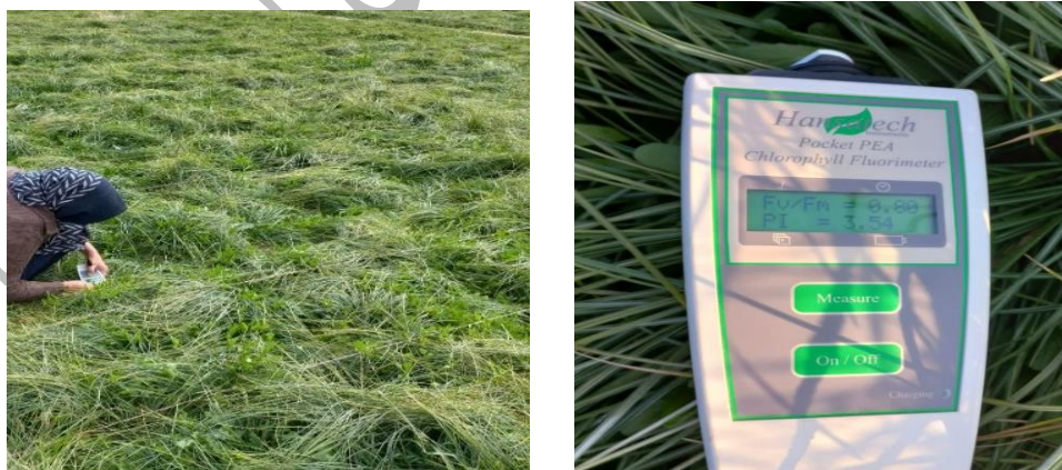
شکل ۱. اندازه‌گیری کلروفیل فلورسانس با استفاده از دستگاه Handy pea Figure 1. Chlorophyll fluorescence measurement using the Handy pea device
