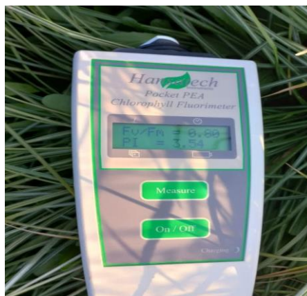
شکل ۱. اندازه‌گیری کلروفیل فلورسانس با استفاده از دستگاه Handy pea Fig 1. Chlorophyll fluorescence measurement using the Handy pea device
