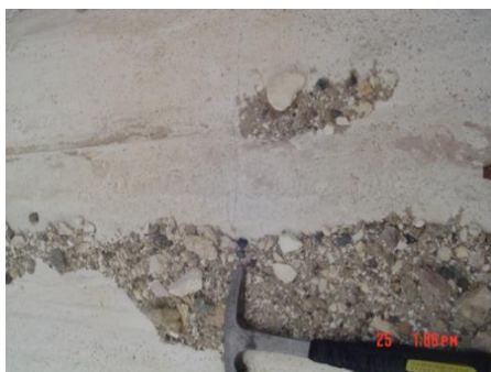
شکل ۵: رگه‌های منیزیت در بخش شمالی معدن با موقعیت ۷۴۳۳۹۷-۳۵۸۳۸۹۷ در ارتفاع ۲۰۹۴ متری و موقعیت هندسی 170/20 (دید شمال باختری)
