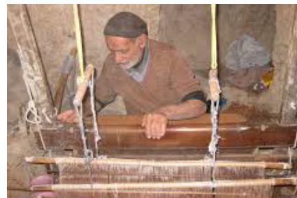
تصویر ۷: دستگاه نساجی مخصوص عبابافی، روستای محمدیه نائین (سایت میراث فرهنگی اصفهان، ۱۳۹۶).
